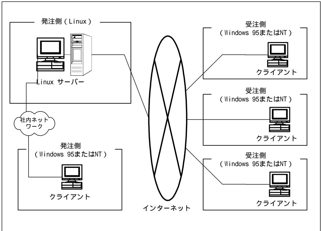
図 2 - 1 ネットワーク構成概要図
